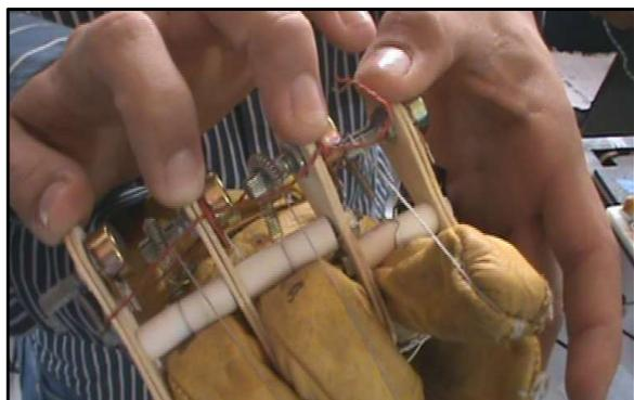
Fig. 3 Guante con potenciómetros accionados por cable para detectar flexión.
