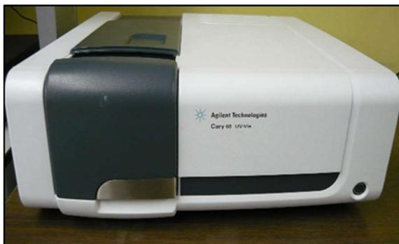
Fig. 1 Cary UV-vis 60 Agilent Technologies®.
